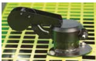
Дождевая крышка на выхлопной трубе
